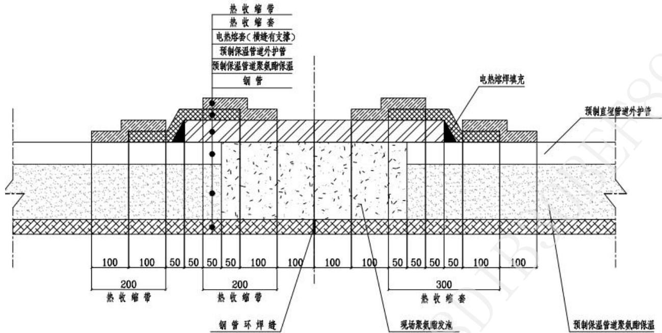
现场发泡料与直管道的发泡料必须一致，发泡时的 PE 封堵：采用 PE 塞焊分别封住发泡孔及放气孔。注意 PE 焊塞一定充分熔焊，焊接牢固。
