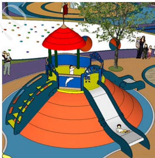
(7) 儿童滑梯：塑胶平台 R=3.5\text{m} , H=1.73\text{m} , 平台上高度 =2.5\text{m} , 工程塑料+不锈钢。
